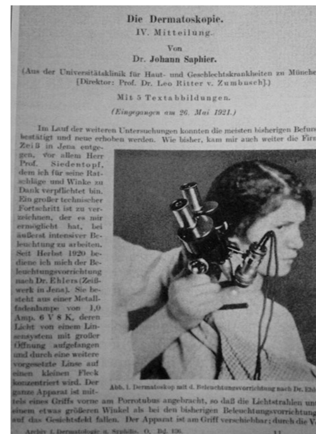
Figura 2 - Microscópio binocular de Saphier com iluminação lateral.
