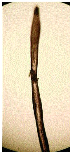
Fig. 3 – Microscopia óptica (20x): Ruptura em internodo.
