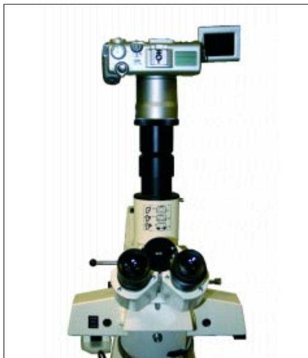
**Fig. 4** – Câmara digital compacta com tubo de adaptação para microscópio óptico.
